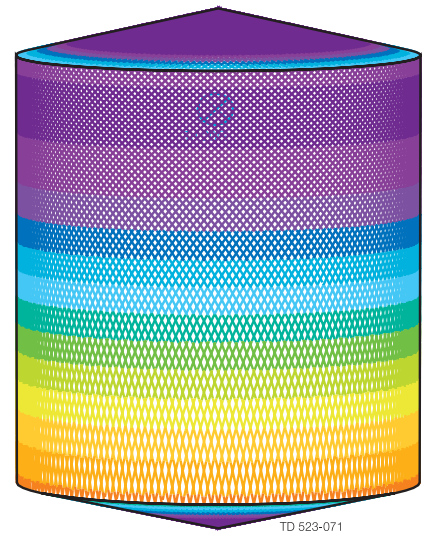
D4,6m H5,5m, Toftejorg TJ 20G, 4 x ø5,5 mm Tempo = 8,3 min, Consumo de água =1.612 l (428 galões)
